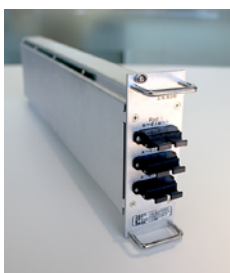
●光スイッチモジュール 結線方式を変更し、光ファイバの配線が容易になるように改良
