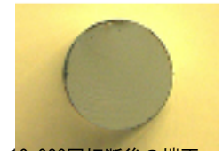
10,000回切断後の端面
