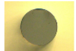
1,000回切断後の端面
