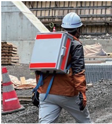
Wi-Fi通信パッケージの外観と機器構成
