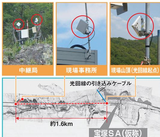
切畑トンネル工事区間の概要とWIPAS配置図
