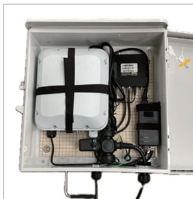
Wi-Fi通信パッケージの外観と機器構成
