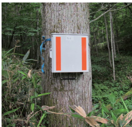
林道工事現場に設置(樹木にベルトで固定)
