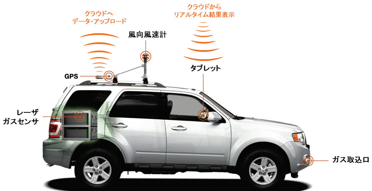
図1 Surveyor システムのハードウェア構成
