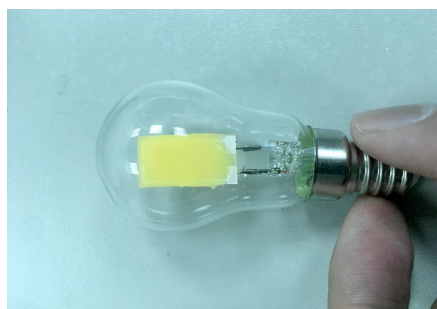
【NTT-AT製GaN FETを用いた小型LED電球】
