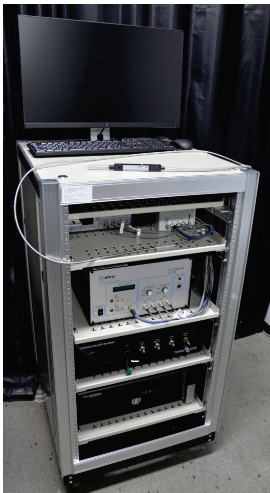
図 3. 開発した光干渉断層計(OCT)の外観
